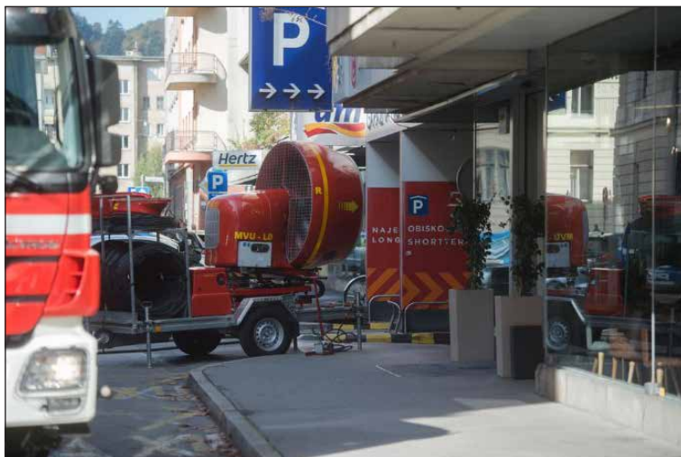
Slika 5. Prozračivanje objekta s velikim nadtlačnim ventilatorom. Izvor: https://www.zurnal24.si/media/img/a6/e8/e143d165d50fd3e18239.jpeg
